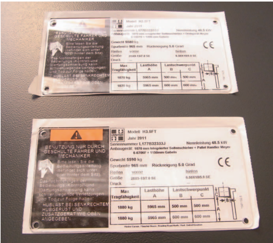
Tragfähigkeitsschilder (Traglastdiagramme) mit der Resttragfähigkeit der Kombination Anbaugerät mit Stapler – in diesem Fall für einen Stapler mit zwei Anbaugeräten.
