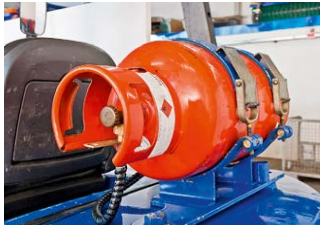
1 Stapler mit Tauchrohrflasche: Das Entnahmeventil ist durch den Schutzkragen gegen mechanische Beschädigungen geschützt.
