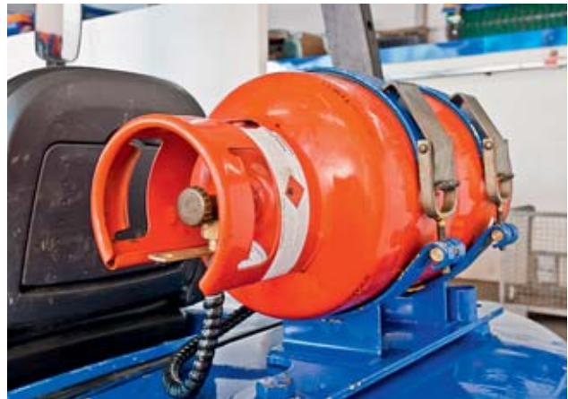
1 Carrello elevatore con bombola dotata di tubo pescante. Qui la valvola di prelievo è protetta contro il danneggiamento meccanico da un collarino.
